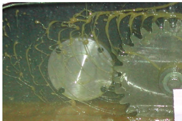
Figure III.12 – Projection centrifuge de l'huile présente sur les dents lors de la rotation du pignon
