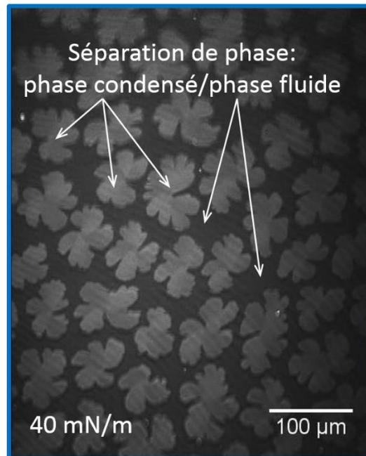
*Fig. 25 Image BAM du surfactant pulmonaire à l'interface air-liquide de la cuve de Langmuir Sa structure est constituée des domaines des lipides condensés ( $E \uparrow$ ) contenant comme on l'a vu auparavant du DPPC en phase solide et du DPPS au centre des domaines. Ces domaines sont repartis dans une masse de phase fluide ( $E \downarrow$ ) constituée d'un mélange de DPPC/DLPC/DPPS dans un état désordonné.*
