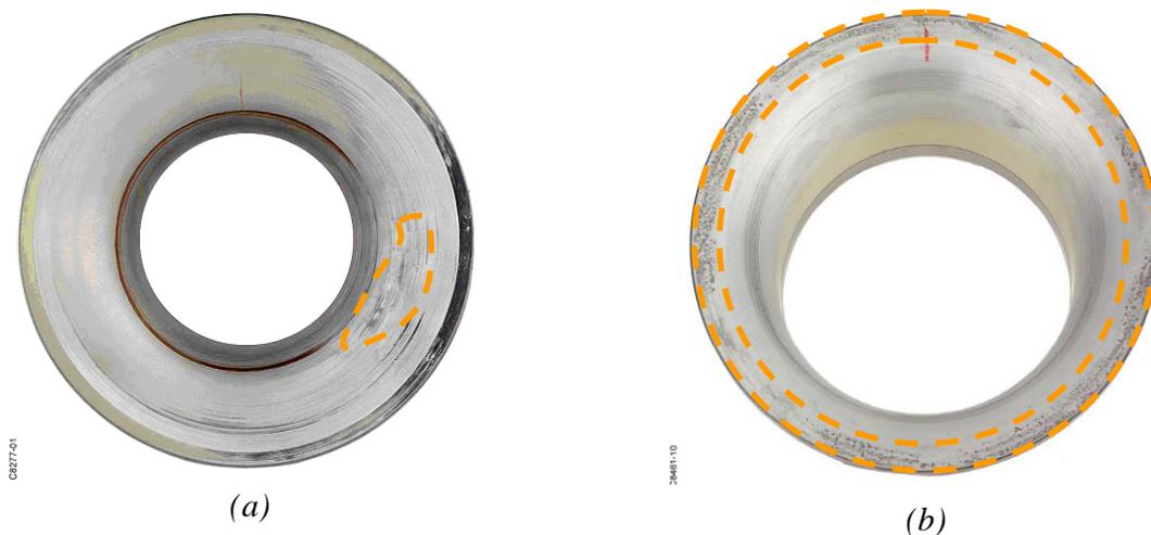
**Figure 1-7 :** Contact rouet/couvercle d'un moteur Ardiden 1H de Turboméca
