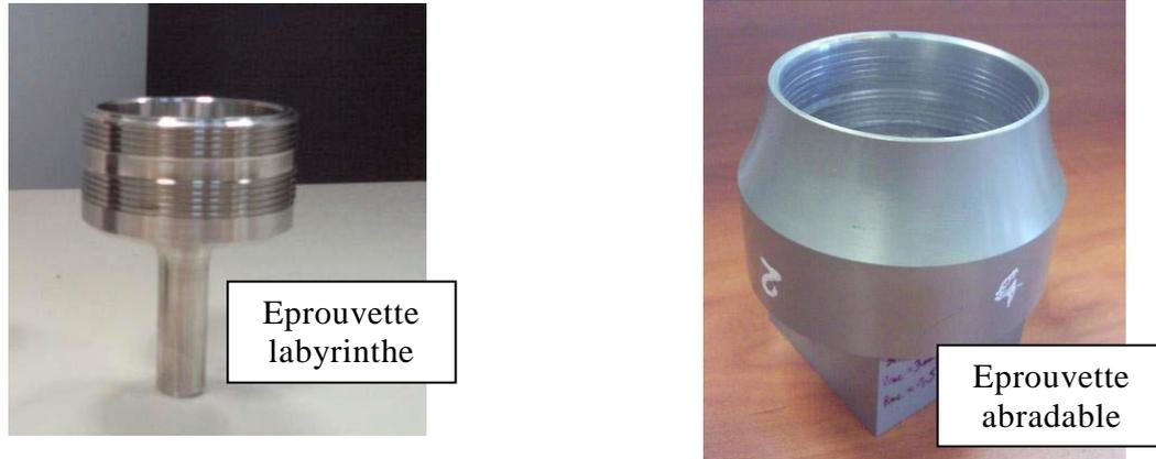
**Figure 3-19** : photos des éprouvettes du joint labyrinthe et de son alésage avec revêtement d'abrasable
