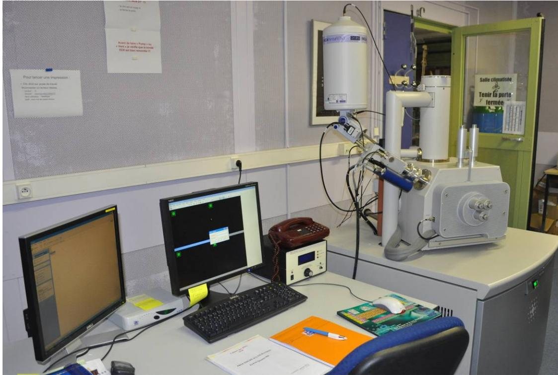
Fig. a5 FEI Quanta 600 SEM
