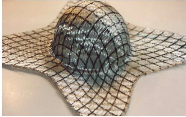
Figure 2.10 : Non-glissement entre les mèches de chaîne et de trame
