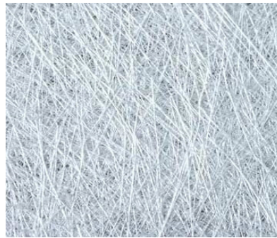
Figure 2.29. Exemple de milieu fibreux à single-porosité (mat de verre)
