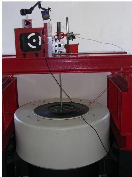
**FIGURE 3.16:** Montage de la manipulation sur pot vibrant
