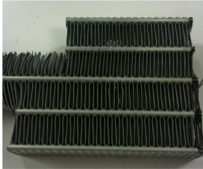
**FIGURE 1.4:** Photo d'un assemblage de tubes et d'ailettes constituant un faisceau de radiateur brasé
