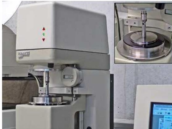
Figure 3-8 Rhéomètre à contrainte imposée
