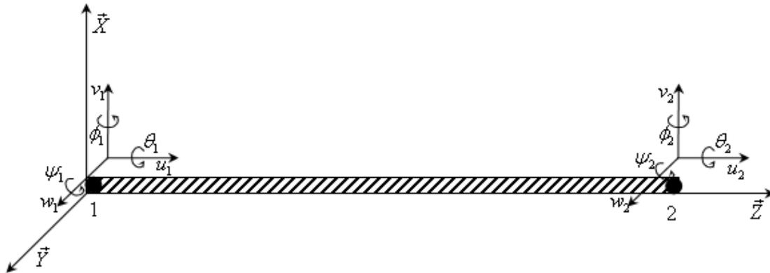
**Figure II-11 : Modèle élément fini de l'arbre**
