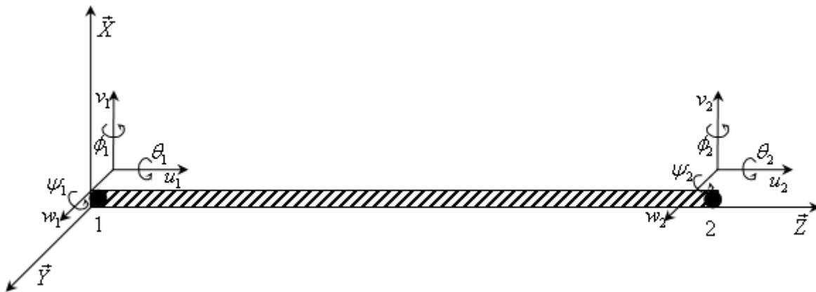
**Figure A.1 :** *Eléments finis d'arbre. Description des degrés de liberté.*
