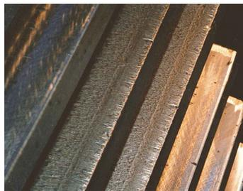
**Figure I-6 :** *Grippage couvrant l'ensemble des dentures [31]*
