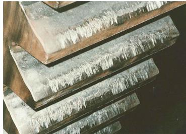
**Figure I-10 :** *Grippage localisé sur les têtes de dent [31]*
