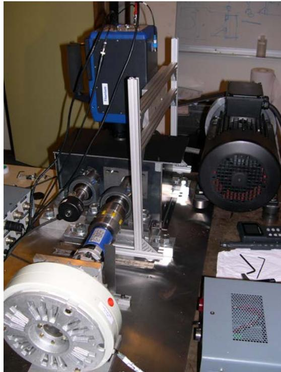
*Figure 4.21 : Banc expérimental pour engrenages en Polyamide 6,6 développé par le LaMCoS*
