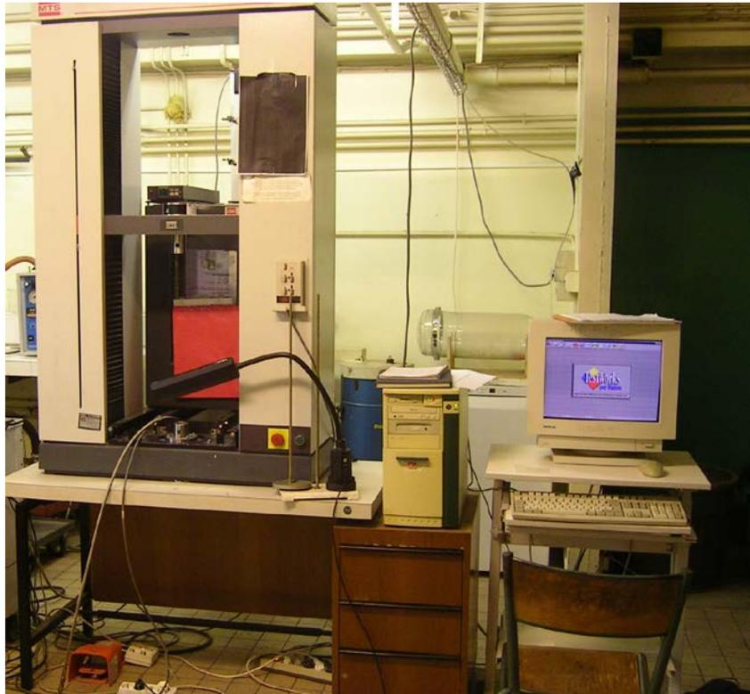
*Figure 2.2 : Machine MTS de traction-compression*
