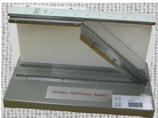
a. flexomètre standard à plan incliné
