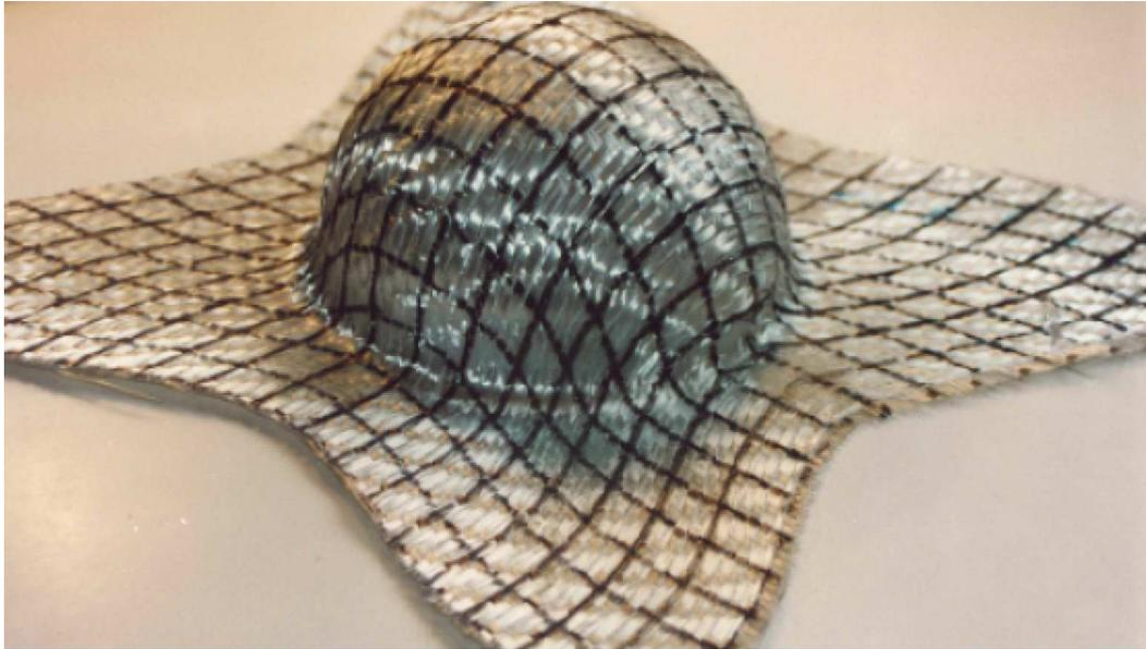
**Figure 2.2 - Non glissement entre les mèches de chaîne et de trame [CHE01]**
