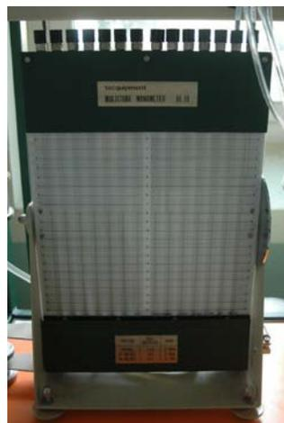
Figure A1-2 : Mesure de la distribution de pression pariétale par tubes piezométriques.
