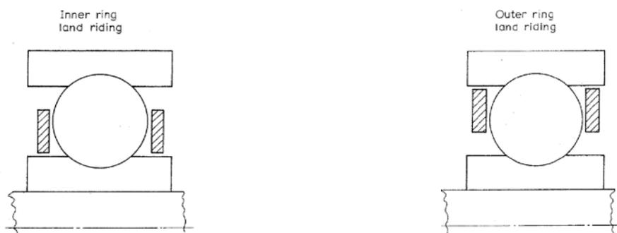
figure I.14 - Guidage de la cage par bague intérieure ou par bague extérieure [HAR\_73]
