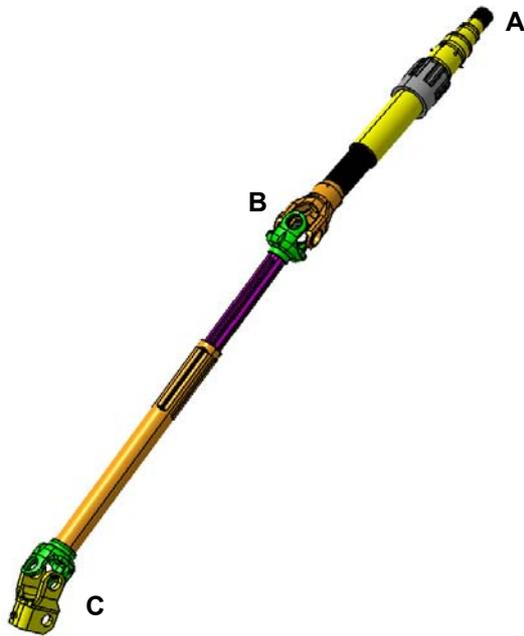
Figure 99 : colonne de la P-EPS D (CAO)
