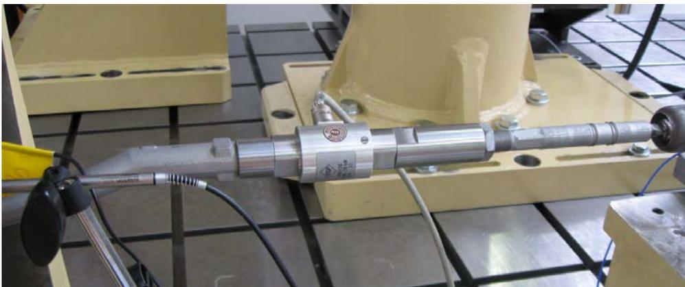
Figure 90 : banc d'essai P-EPS D, mesure des efforts dans les biellettes
