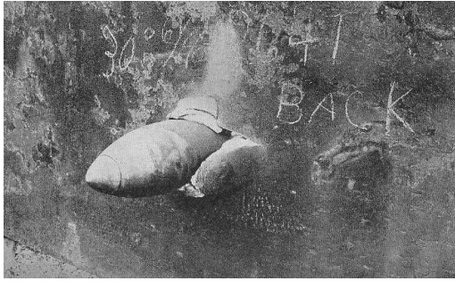
(a) Impact incliné d'un projectile sur une plaque d'acier (Source US Navy [84])
