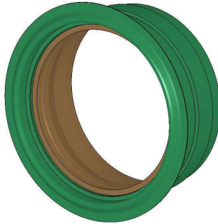
FIG. 4.4: Vue générale de l'anneau (en marron) introduit dans le blindage (en vert), la partie torique de la pièce marron correspond à la tôle de fixation
