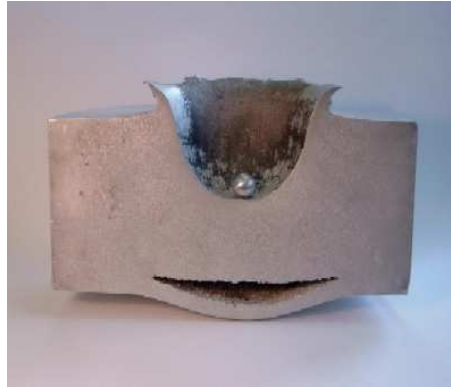
FIG. 2.15: Résultat de l'impact d'une bille d'aluminium sur une plaque épaisse d'aluminium de 18 cm à la vitesse de 6.8 km/s (Source ESA)
