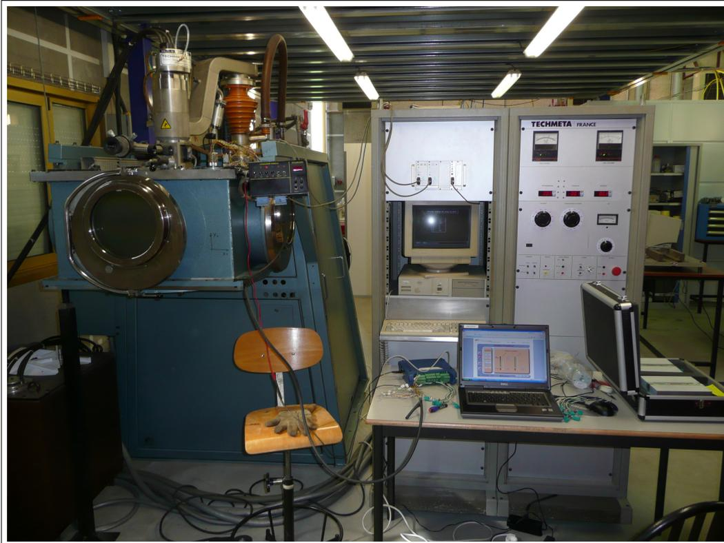
**FIGURE 2.15:** *Dispositif de soudage par faisceau d'électrons*
