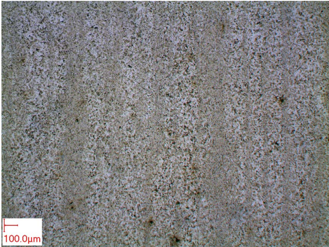
FIG. 2.2 – Structure de l'acier 100Cr6 trempé dans la masse à 170^{\circ}\text{C} (grossissement \times 50 )
