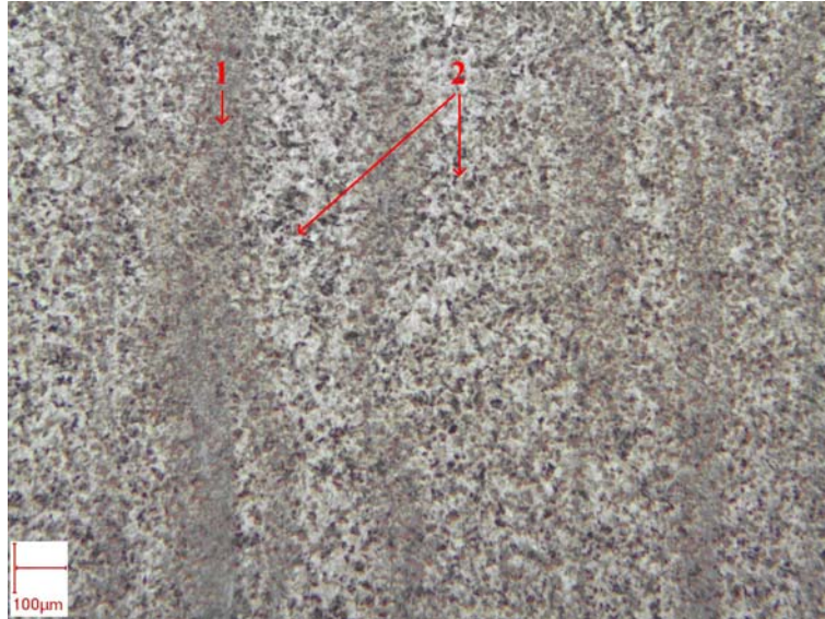
FIG. D.2 – Structure à coeur (attaque C1)
