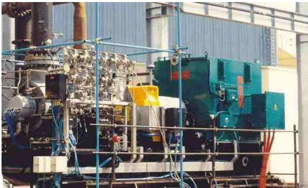
Figure 1.23 – Groupe moteur, multiplicateur, compresseur centrifuge
