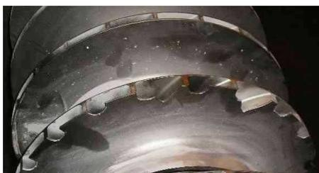
Figure 7.23 – Incidents survenus au diamètre extérieur ou au bord d'attaque de roues de compresseurs
