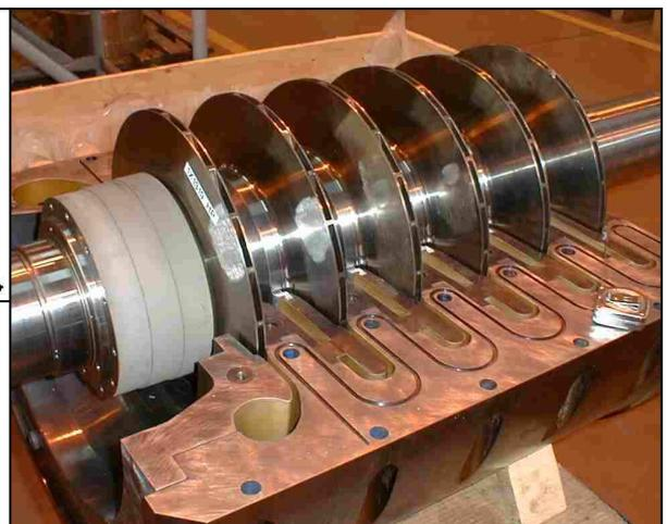
Figure 1.8 – Cartouche de compresseur centrifuge haute pression
