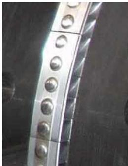
Figure 7.3 – Montage en paquets des aubages tournants
