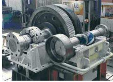
Figure 1.21 – Réducteur à axes parallèles
