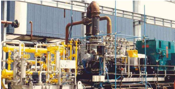
Figure 4.5 – Compresseur centrifuge en essais à pleine charge
