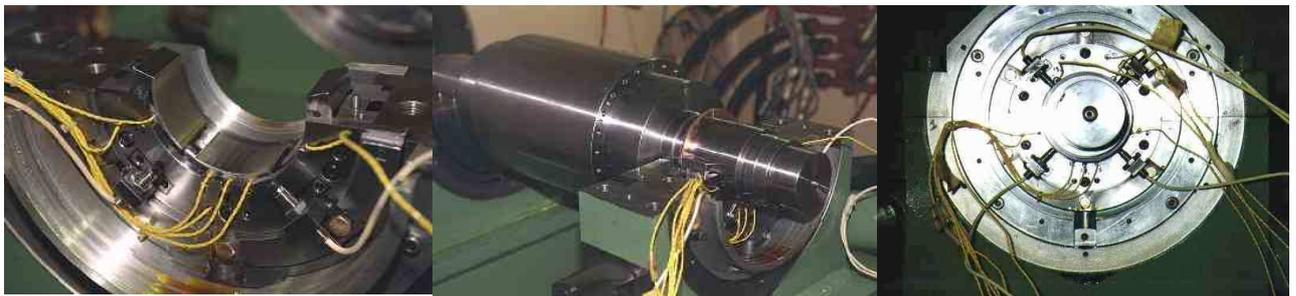
Figure 4.10 – Essais de caractérisation dynamique de paliers – Instrumentation
