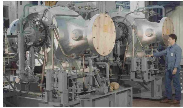
Figure 1.12 – Corps de compresseurs pour station de gazoduc
