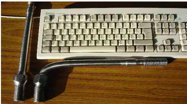
Figure 3.35 – Tirant déformé après rotation sur sa propre vitesse critique
