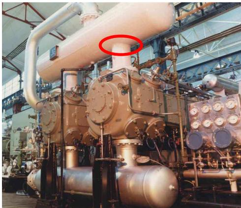
Figure 8.6 – Apparition d'une fissure sur une bouteille antipulsatoire
