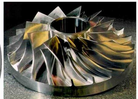
Figure 1.18 – Moyeu de roue 3D avec aubes intercalaires
