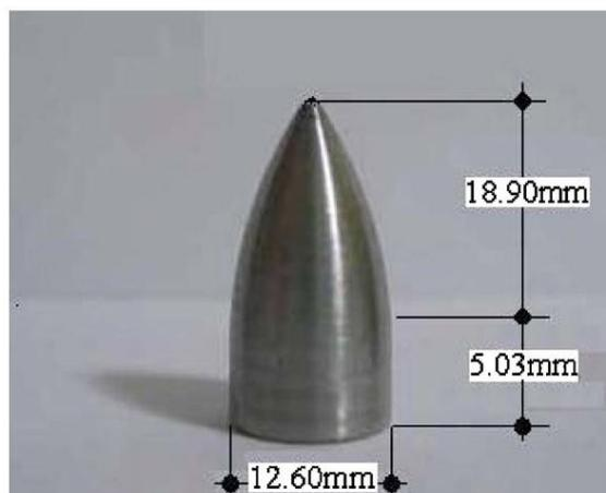
**FIGURE 2.21:** Photo et dimensions du projectile
