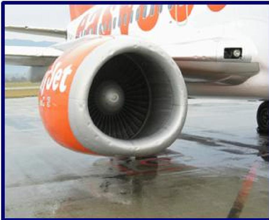
**FIGURE 1:** Exemple de dégats subits par un moteur d'avion lors de la traversée d'un nuage de grêle
