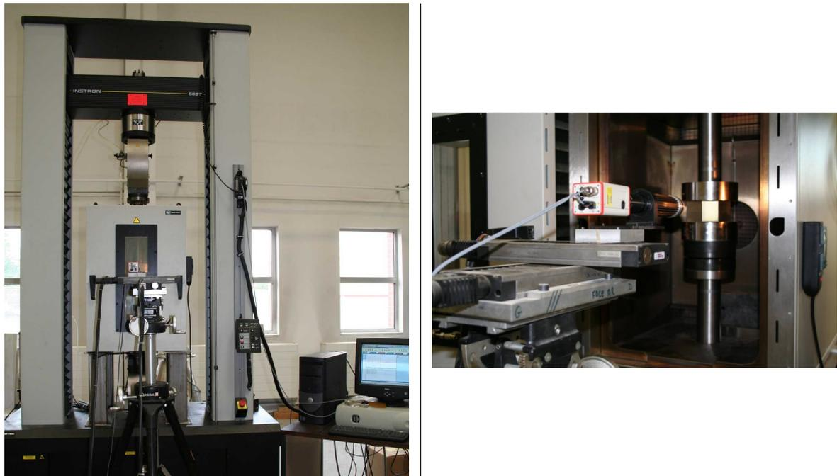
**FIGURE 3.22:** Photographies de l'installation "Vérin rapide"
