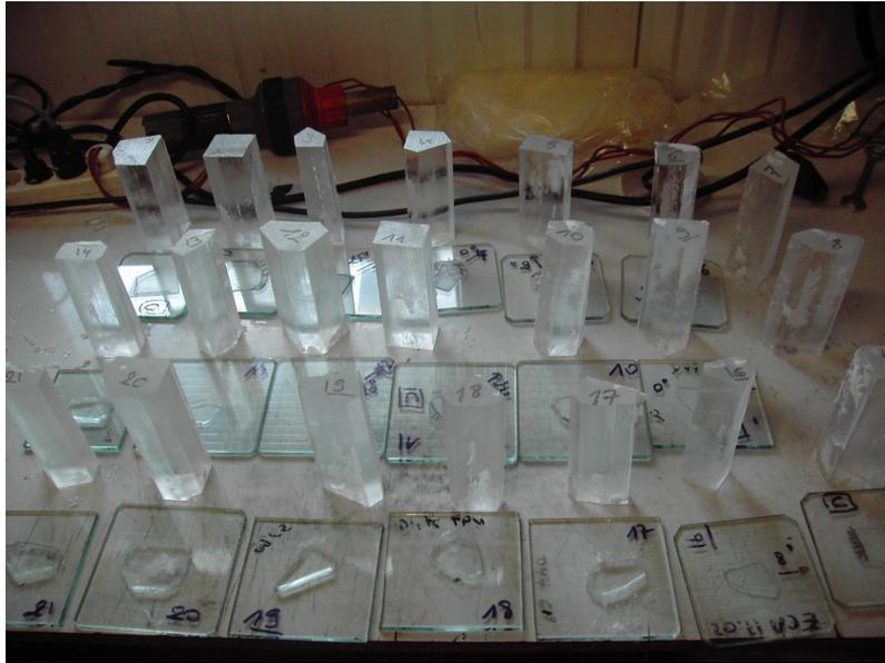
**FIGURE 4.1:** Photo de l'ensemble des carottes découpées et analysées
