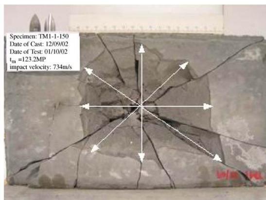
**FIGURE 2.23:** Exemple d'un cratère et de la détermination de son diamètre
