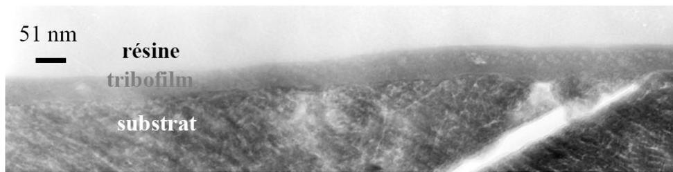
**FIGURE 1.28:** image TEM d'une coupe transversale de tribofilm de ZnDTP[MIN 04]
