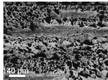
**FIGURE 1.15:** micro-écaillage et fissure longitudinale observée à 3,5 GPa sur de l'acier M50 [NEL 98]
