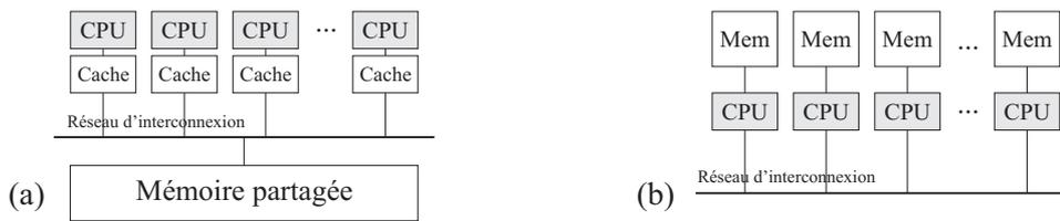
**Figure 1.21:** Schémas d'architectures parallèles : (a) Mémoire partagée - (b) Mémoire distribuée.
