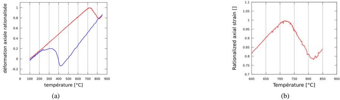
FIG. 4.15 – Variation typique de la température lors du changement de phase austénitique du 16MND5.
