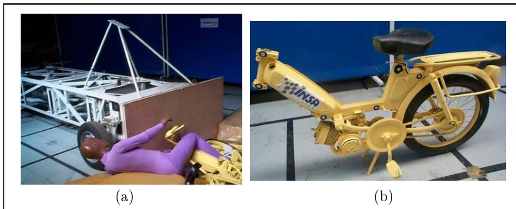
FIG. 4.24 – (a) Barrière mobile européenne équipée d’une planche en bois. (b) Le cadre du cyclomoteur utilisé pour les différents essais de test–crash
