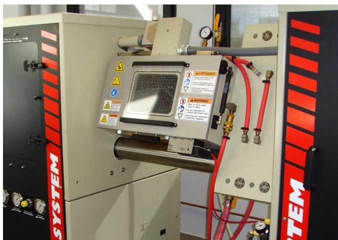
Figure 2.11 – Simulateur thermomécanique Gleeble 3500 utilisé lors de cette thèse.
