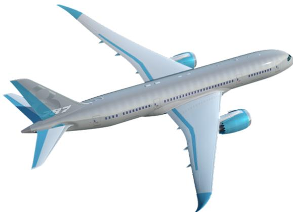
**FIGURE 2** – Image de l’avion de ligne Boeing 787 Dreamliner. Les zones en bleu représentent l’utilisation de composites sandwich. Source : <https://www.boeing.com/commercial/787/by-design>, consulté le 30/06/2023.
