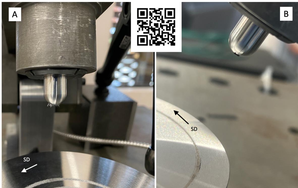
**Figure IV.10** – *Comparaison macroscopique du troisième corps lors de l'ouverture du contact pour des essais sous A) Argon et B) atmosphère libre. QRcode : Extrait vidéo d'un essai sous atmosphère. (SD = Sliding Direction)*
