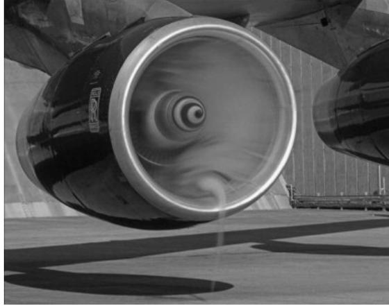
FIGURE I.6 – Vortex de sol sur un turboréacteur.
