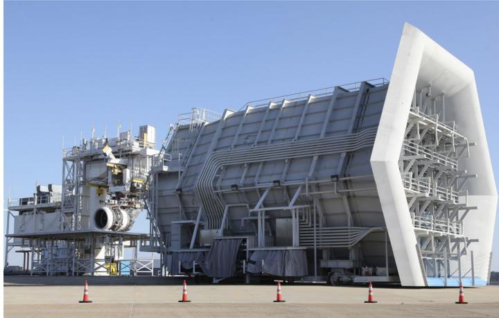
FIGURE IV.8 – Soufflerie *General Electric* de Peebles lors des essais en vent de travers avec faux sol pour le démonstrateur de soufflante.
