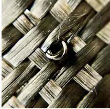
(a) Sortie partielle du piquage
