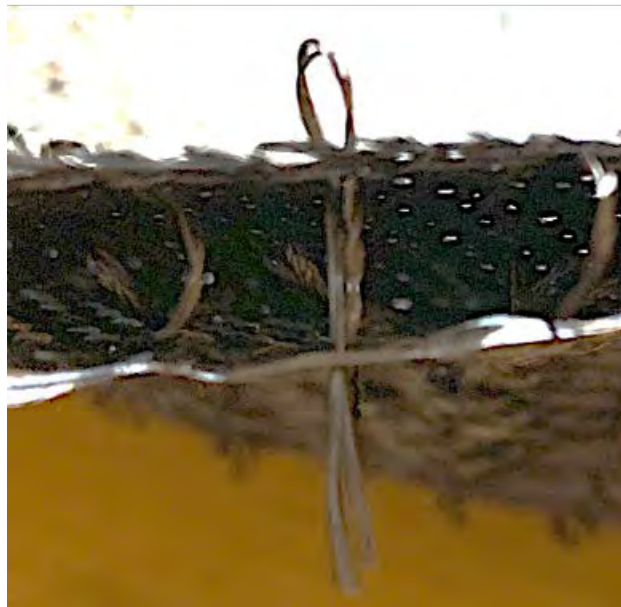
FIGURE 4.4 – Boucle de piquage dans une préforme piquée
