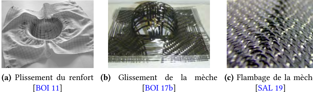
FIGURE 1.18 – Les différents défauts pendant le processus de l'emboutissage
