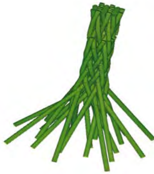
(a) Préforme 3D tressée [WAN 01]
