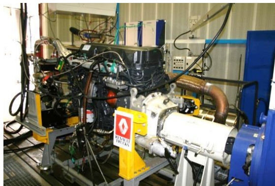
Figure 51 : Moteur en cellule d'essais pour un test de durabilité de 1000h
