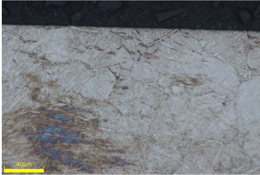
Figure 1-21 : Liseré de carbures dans une couche de diffusion
