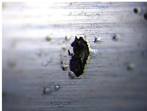
Figure 1-17: Micro-écaille sur un roulement - Image NTN-SNR
