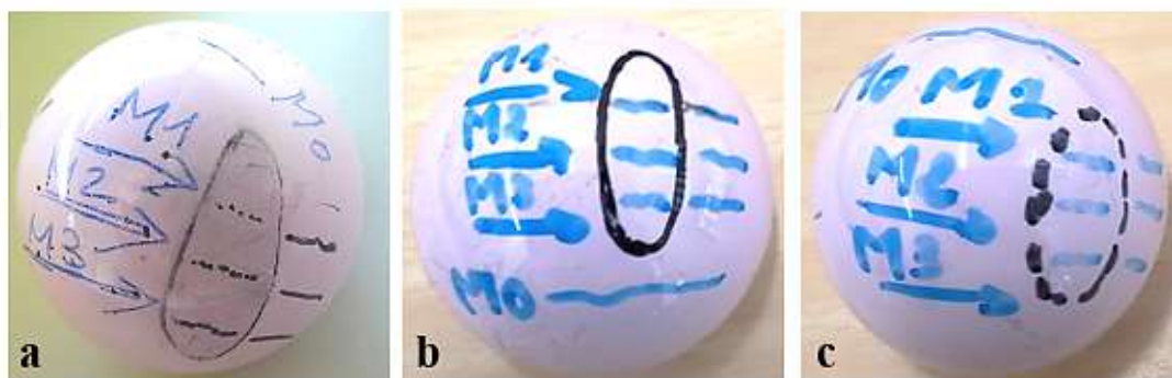
Figure III. 4. Localisation des sites (M0, M1, M2 et M3) pour l'analyse de rugosité des têtes fémorales du a) patient 1, b) patient 2 et c) patient 3.
