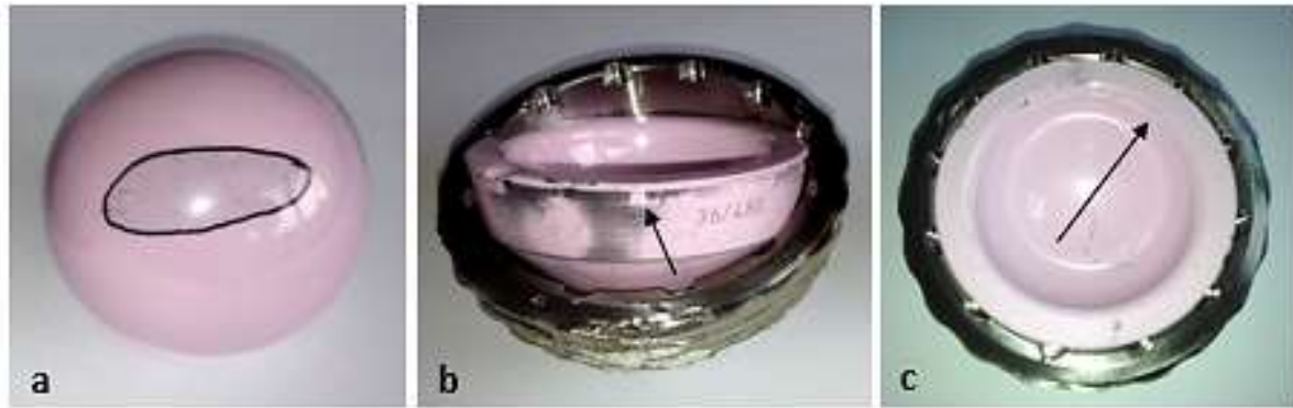
Figure III. 1. Implant du patient 1 : a) bande d'usure (« Stripe wear »), b) traces de frottement sur la zone d'encoche indiquant la rotation de l'insert dans le métal-back et c) aucune trace d'impingement observée sur l'insert
