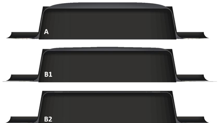
**FIGURE 5.62** – Comparaison entre l'approche usuelle, l'approche incrémentale et l'approche incrémentale avec gestion des conditions aux limites
