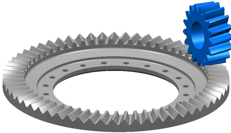
Figure 1 : Engrenage face hélicoïdal (Facet)
