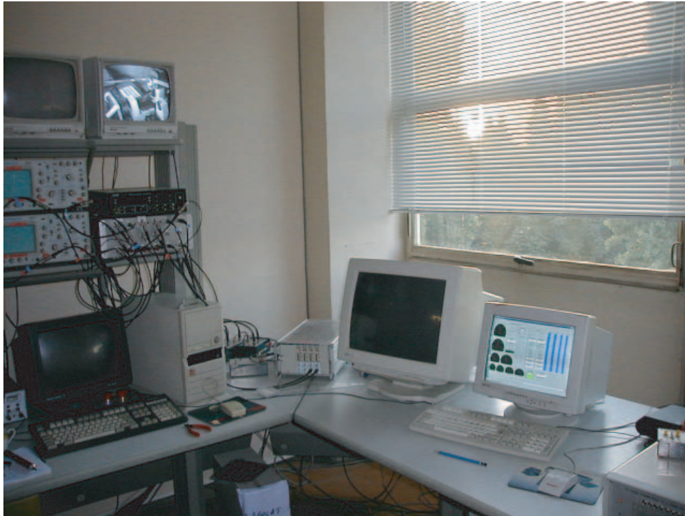
FIG. 3.41: Photographie de la zone de surveillance de la poutre en rotation par caméra
