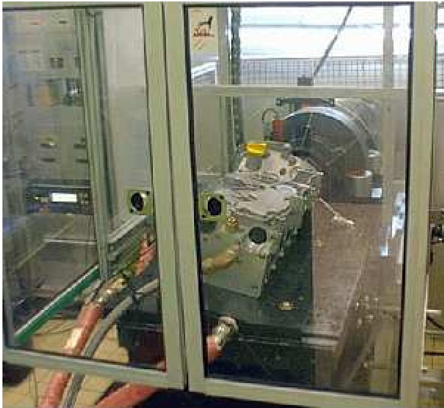
FIG. 2.1 – Banc de caractérisation dynamique de la distribution
