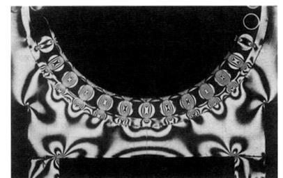
FIGURE 1.4 – Étude photo élastique d'un roulement à rouleaux. Eimer, 1964, [10].
