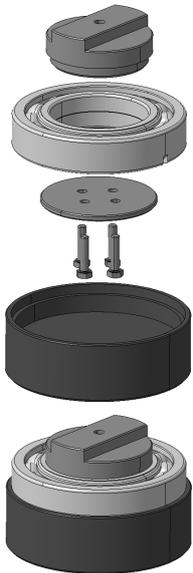
FIGURE 5.2 – Support du roulement.
