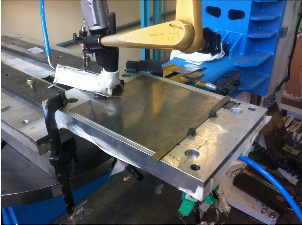
**Figure 5.8 – Montage expérimental pour la ligne de fusion par soudage TIG**
