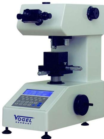
La dureté Vickers se mesure grâce à une pointe pyramidale normalisée en diamant de base carrée et d'angle au sommet de  $136^\circ$ . La pointe est appliquée progressivement sous l'action d'une force  $F$  sur la surface du matériau à tester et est maintenue pendant un temps précis. Si le matériau est plastiquement déformable, une empreinte de surface latérale  $S$  et de profondeur  $e$  reste suite au retrait de la charge. La dureté est exprimée de la manière suivante :
