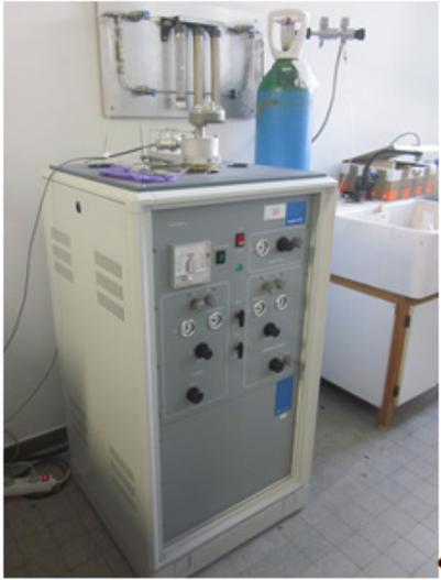
Figure 1.18 - Machine DSC utilisée au laboratoire SIMAP
