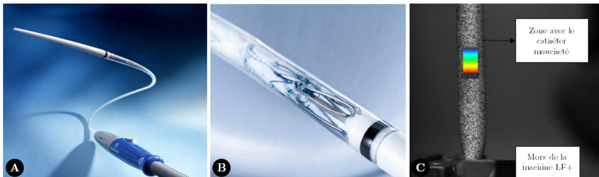
FIGURE 2.25 – (A-B) Cathéter avec une endoprothèse non déployée à l'intérieur (images issues de Medtronic<sup>©</sup>) (C) Tests de traction sur la partie contenant l'endoprothèse mouchetée en blanc sur fond noir (Mouktadiri, 2013).
