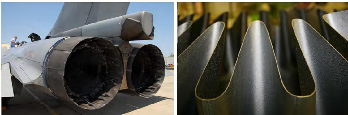
(a) Volets froids en composites thermostructuraux C/SiC (Avion de combat Rafale).
