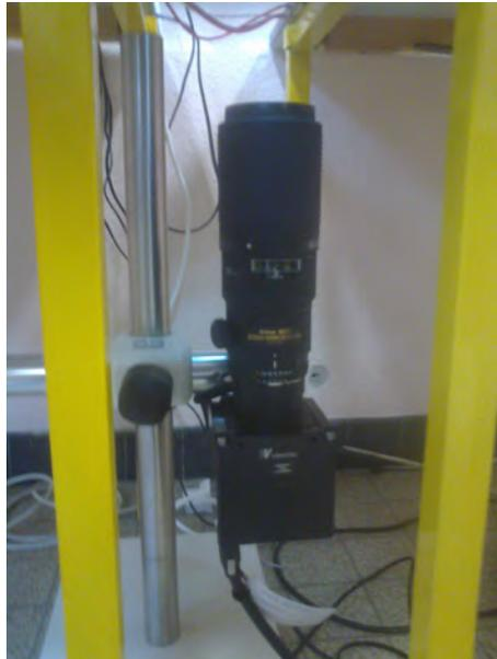
FIGURE 5.5 – Caméra Haute résolution à 29 Mégapixels.
