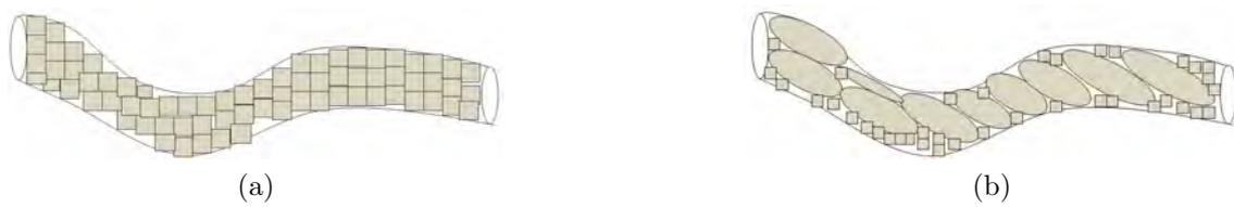
FIGURE 3.28 – Représentation schématique d’une description géométrique d’une fibre de composites tissés (a) séries de cubes (b) séries de cubes+ellipsoïdes.
