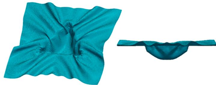
FIGURE 7 – Simulation du retour élastique d'un tissu avec retrait d'un poinçon tétraédrique. D'après [1].
