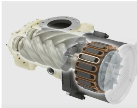
Figure 1. Compresseur à vis avec rotor en porte-à-faux (@ Nidec Leroy Somer).
