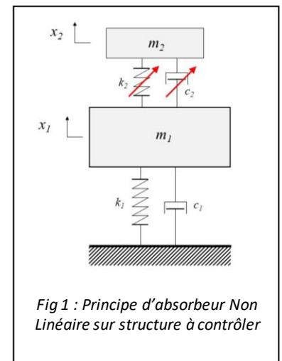
Fig 1 : Principe d'absorbeur Non Linéaire sur structure à contrôler
