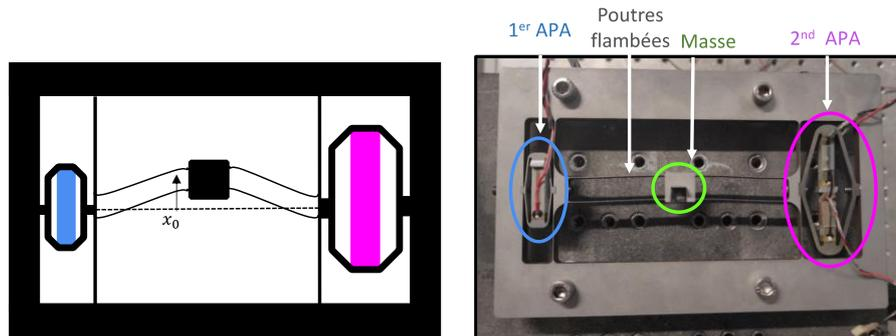
La bistabilité du système provient du flambement de 2 poutres. Une tension électrique appliquée à un des APA latéraux permet de piloter le flambement en ajustant la contrainte latérale sur les poutres. Le NES bistable, présente de multiples comportements non-linéaires : régimes de fonctionnement autour d'une des positions stables, des deux positions stables, résonances subharmoniques et superharmoniques, chaos, etc. [1-3]
