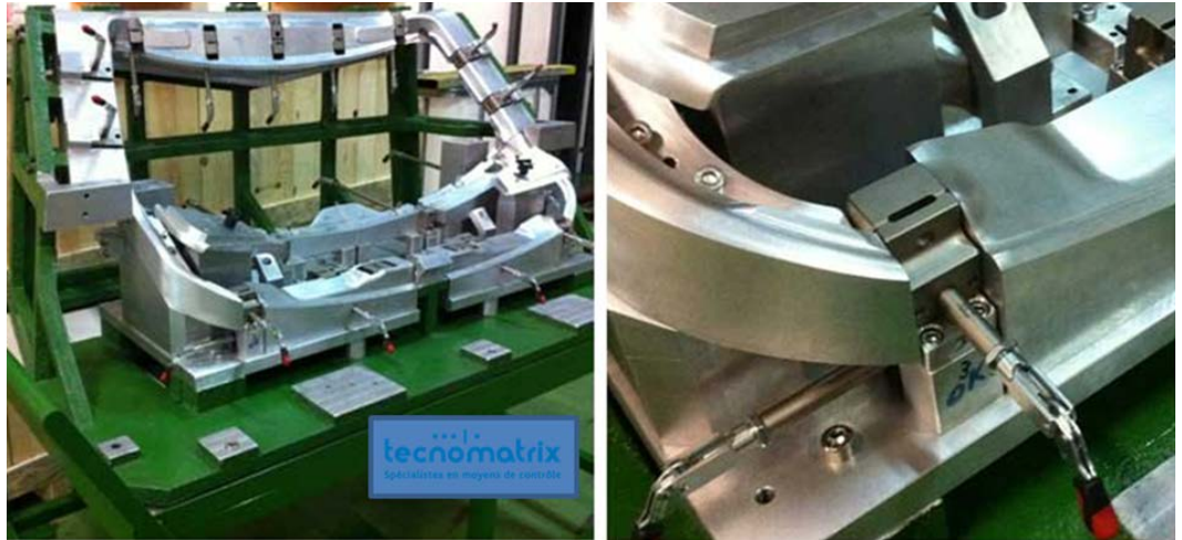
Figure 78 : Montages industriels de contrôle de pièces déformables
