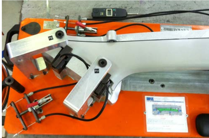
Figure 89 : Moyen de contrôle avec départs de références
