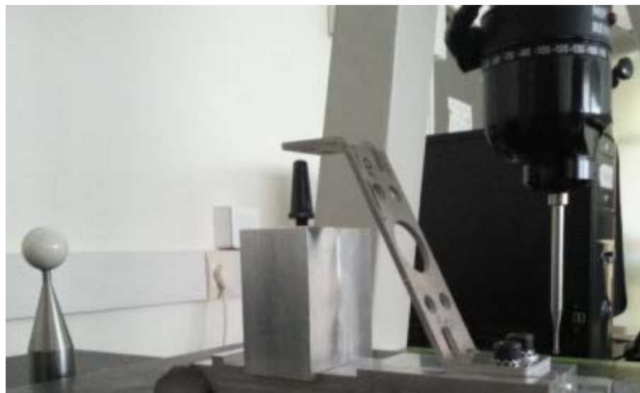
Figure 67 : Montage de contrôle de la pièce déformable simple
