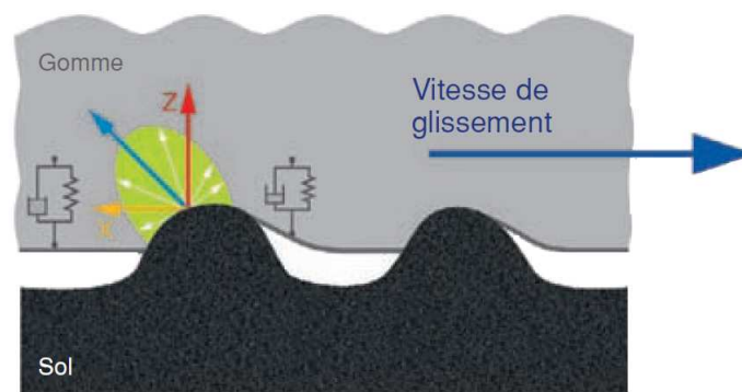
FIGURE 1.5: Vue en coupe du phénomène d'adhérence par indentation
