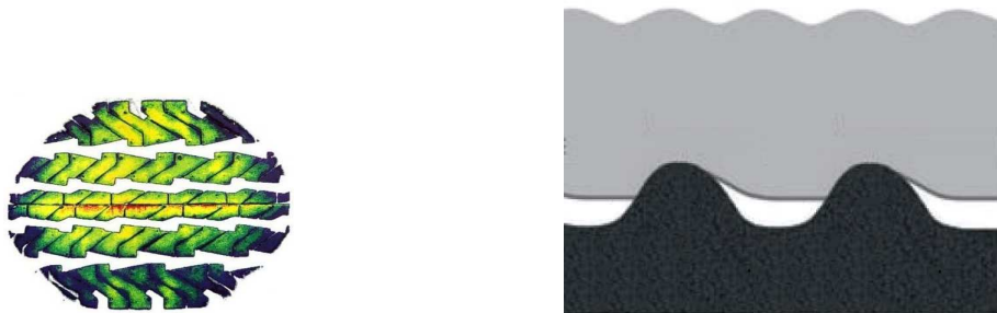
FIGURE 2.1: a) Distribution de pression de contact , b) Zoom sur l'indentation de la route sur le pain de gomme .
