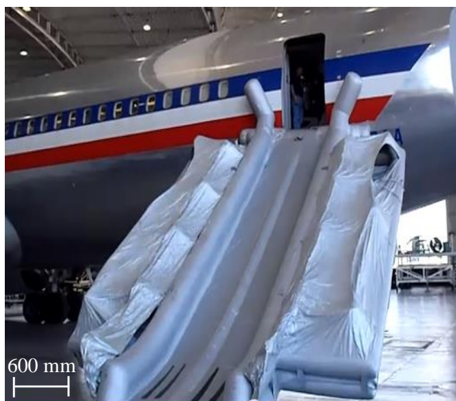
Figure I. 2 : toboggan d'évacuation d'urgence
