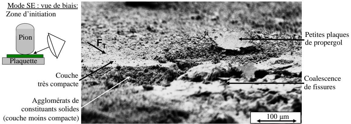
Figure III. 5 : observation d'une zone ayant subi une initiation dans les sections 2 et 4 de l'aire de contact
