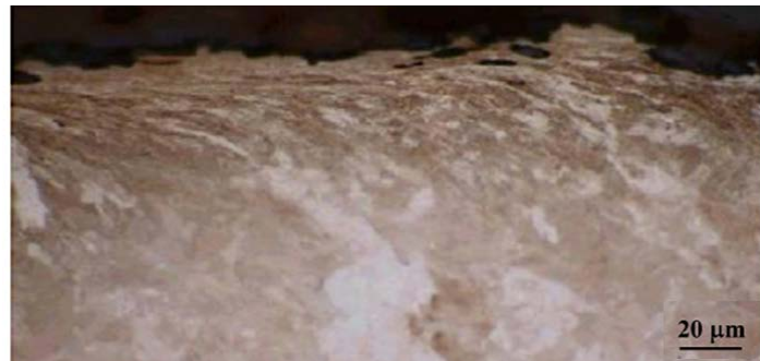
Figure I.3-2 : Élongation des grains de perlite dans les couches superficielles d'un rail en service [ALW 13]
