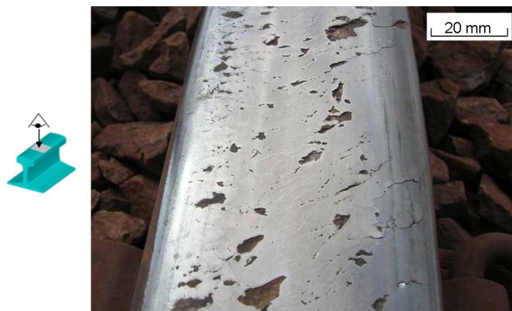
Figure I.3-6 : Écaillages multiples de la bande de roulement de rail [SNC 02] Code UIC 11 222
