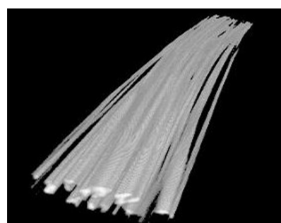
Figure 1.6: Tomographie-X d'une mèche de 300 tex
