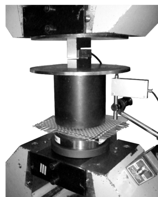
Figure 1.21: Essai de compaction sur renfort
