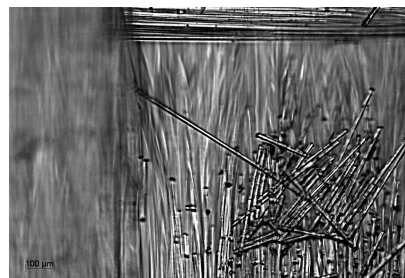
Figure 2.11: Vue microscopique d'une éprouvette après essai de frottement
