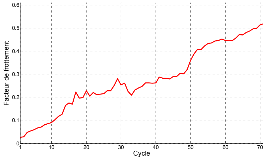
Figure II. 3 - Facteur de frottement moyen par cycle en fonction des cycles d'essai
