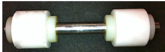
FIGURE 4.28: Banc de Hopkinson - Impacteur avec paliers de guidage.
