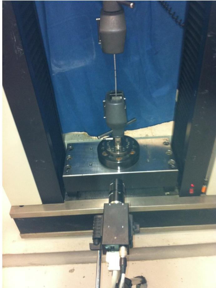
**Figure4.2. Dispositif de traction sur mèches**
