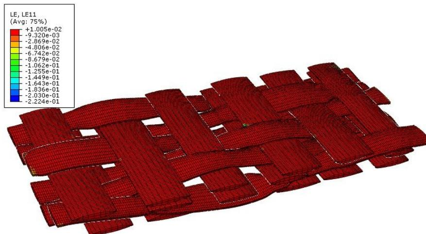
Figure5.14. Géométrie déformée d'une maille élémentaire de G1151® sous traction équi-biaxiale
