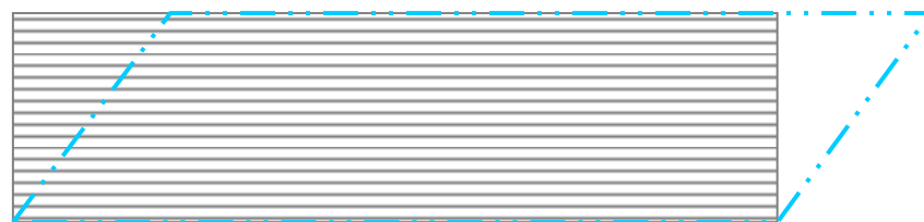
Figure 17 - Cisaillement transverse de la mèche
