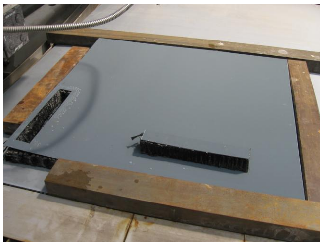
Figure 104 - Fixation de la préforme dans la machine jet d'eau
