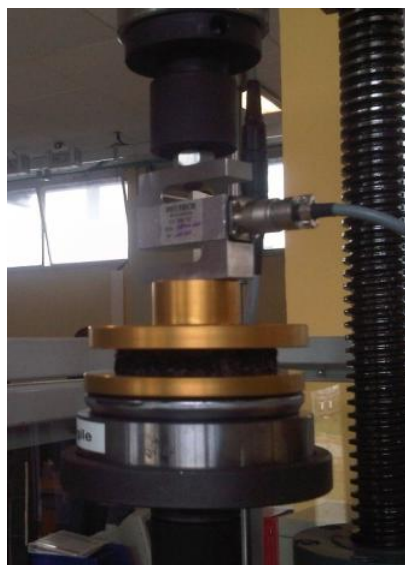
Figure 32 - Module d'essai de compression transverse
